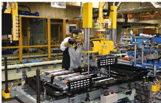
宇品地区にあるマツダ本社工場内バッテリー組立ラインの生産風景。AGVによって運搬されてきたバッテリーパック用フレームに、この写真では人の背後の位置に順次、流れてくるバッテリーパックをこのように載せていく。この後に同じ作業員がホルドでの固定や小型部品、上部カバーなどを装着してから、次の燃料タンクを装着する工程へと進む。
