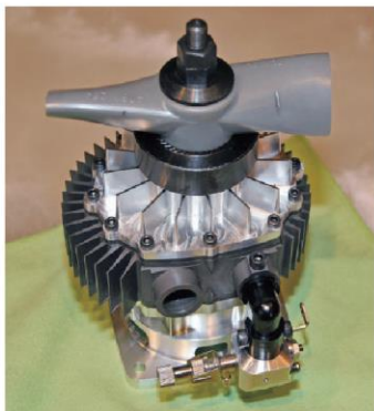
← 最初のRE開発陣、いわゆるRE四十七士のメンバーだった室木 巧氏が見せてくれた小型の航空機用シングルローター空冷RE。どこかで無人機に使われているかもしれない。我われの知らないところでREは使われているという例だ。
