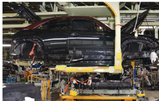
MX-30 R-EVモデルに燃料タンク合体済みのバッテリーパックが装着される工程。この後にBEV、PHEV、ICEといった異なるパワードレーンが搭載される工程となるが、すべてのユニットで搭載工程と設備は共通とし、専用部の極小化を目的としてアタッチメント治具だけを入れ替えるだけで対応している。様々な車種やパワードレーンを同じラインで生産可能だ。
